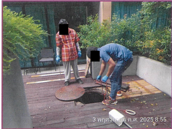
ภาพที่ 1-2 แสดงการเก็บตัวอย่างน้ำผ่านการบำบัด อาคาร 7 (EFFLUENT)
